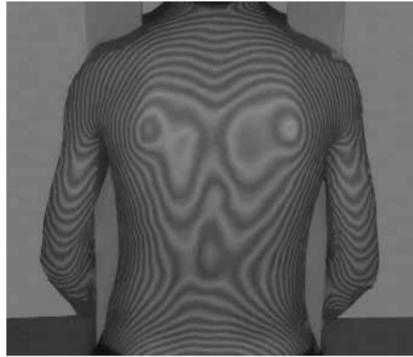
1. 体の背面までの距離や形状を3次元で測定した定量的データを基にしており、従来のモアレ縞に比べ鮮明で正確な等高線を表示する
