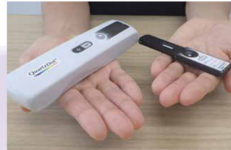
開発中の測定チップと検出装置のイメージ チップ(右)に唾液を滴下し、検出装置(左)で数値を測定する。
